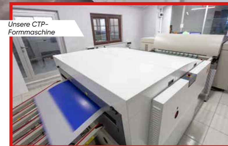
• In unseren CTP-Maschinen werden die Druckformen Ihrer Aufträge abgenommen und an die Produktionsabteilung weitergegeben...
