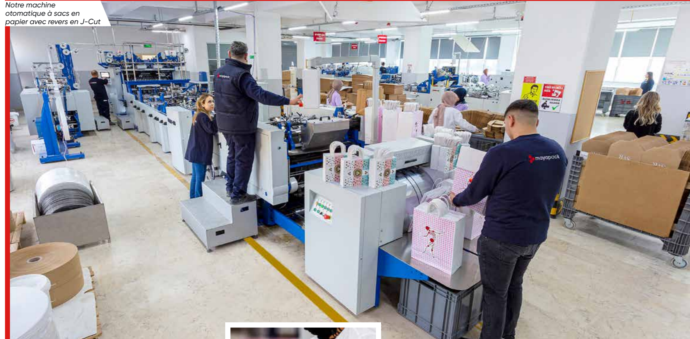
Notre machine de fixation automatique de cordes et de rubans pour sacs en papier de luxe
